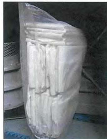
ภาพที่ 2.2-3 ถุงกรองสำรองสำหรับระบบดักฝุ่นแบบถุงกรองของโครงการ
